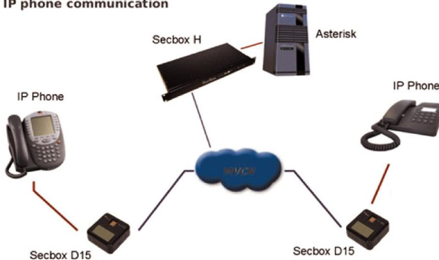
La transferencia de los datos VoIP es un flujo de datos encriptado y protegido (un red virtual cerrado) entre el Secbox Enterprise del servidor y los Secbox de los clientes.
